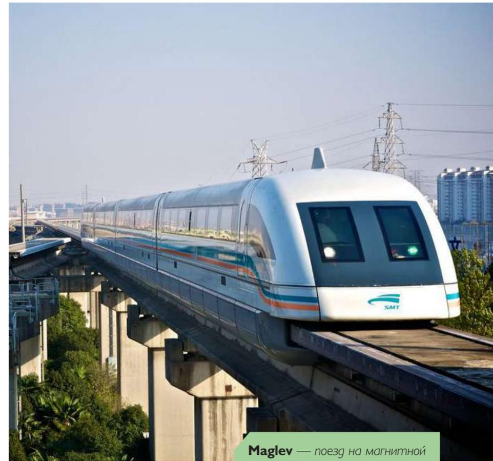
**Maglev** — поезд на магнитной подушке, то есть удерживаемый над полотном дороги, движимый и управляемый силой электромагнитного поля. Такой состав, в отличие от традиционных поездов, в процессе движения не касается поверхности рельса. Super-Maglev — технология, позволяющая избежать сопротивления воздуха, что в теории позволит поездам разогнаться до скорости 3 тыс. км/ч.
