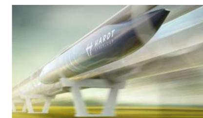
**Hyperloop** — проект вакуумного поезда, предложенный в 2013 г. основателем SpaceX и Tesla Илоном Маском. Поезда-капсулы должны будут передвигаться по специальному трубопроводу низкого давления, поднятого над землей на опорах. Предположительно они смогут достигать скорости до 1200 км/ч.
